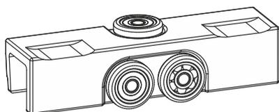
Рельса в сборе с роликами, стопорами и напольной направляющей.
