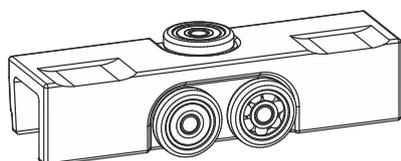
Рельса в сборе с роликами, стопорами, заглушками и напольной направляющей на двухстворчатую дверь до 100кг (длина 5м)
