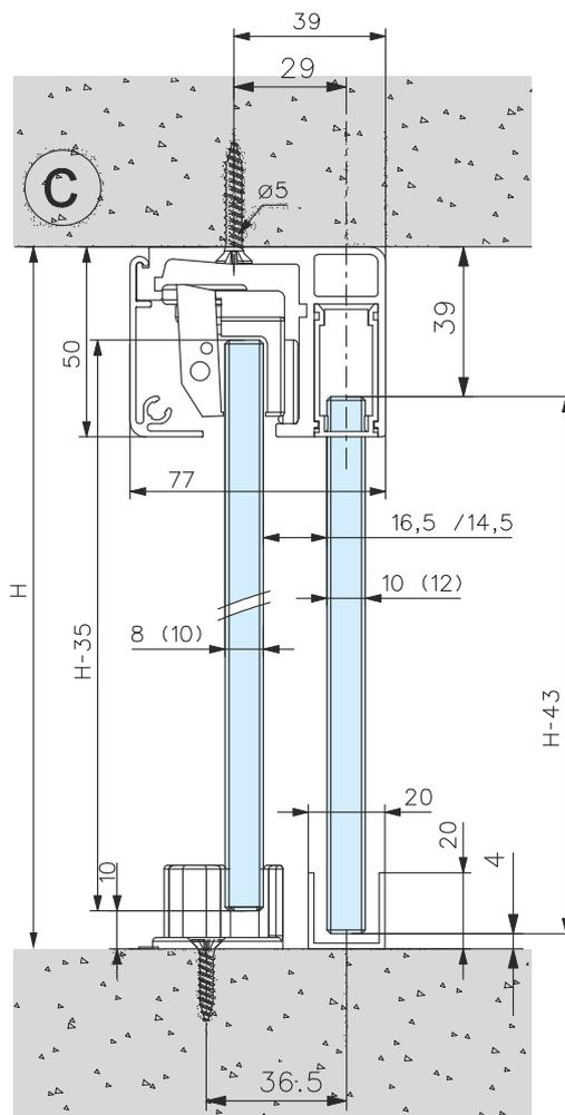
Рельса в сборе с роликами, стопорами, заглушками и напольной направляющей на двухстворчатую дверь до 100кг (длина 5м)
