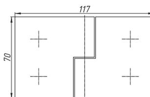
Петли для душевых кабин без резки уплотнителя
