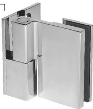
Петля стекло-стена без фиксации с подъемом на 4,5 мм при открывании и самозакрывание при 10...15°. Толщина стекла: 6...8 мм
