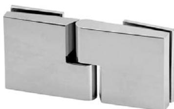
Петля стекло-стекло 180° без фиксации с подъемом при открывании и самозакрывание при 20°. Толщина стекла: 8...10 мм
