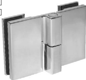
Петля стекло-стекло без фиксации с подъемом на 4,5 мм при открывании и самозакрывание при 10...15°. Толщина стекла: 6...8 мм
