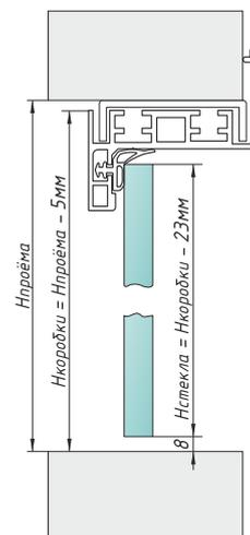
\* - Компенсация неравномерности стены
